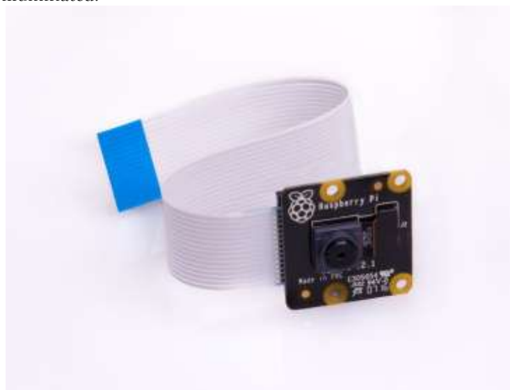
Fig. 2. Raspberry Pi NoIR Camera V2 Module
